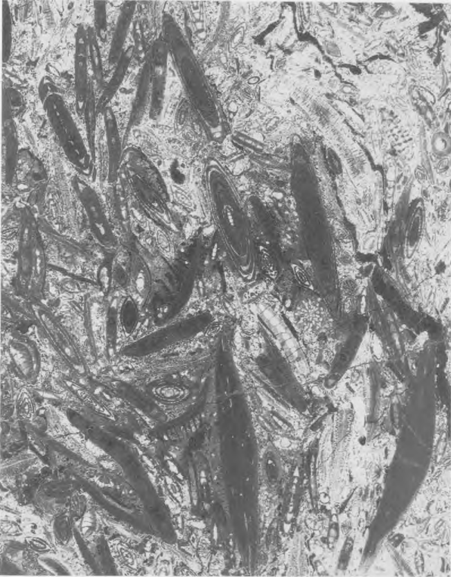
Nummulitenkalk. Das Gestein wird vorwiegend von linsenförmigen Großforaminiferen aufgebaut. Es ist wolkig vererzt. (Negativbild [vererzte Stellen erscheinen hell!]; Bildbreite original ca. 3 x 4,5 cm) (Abb. 3).
