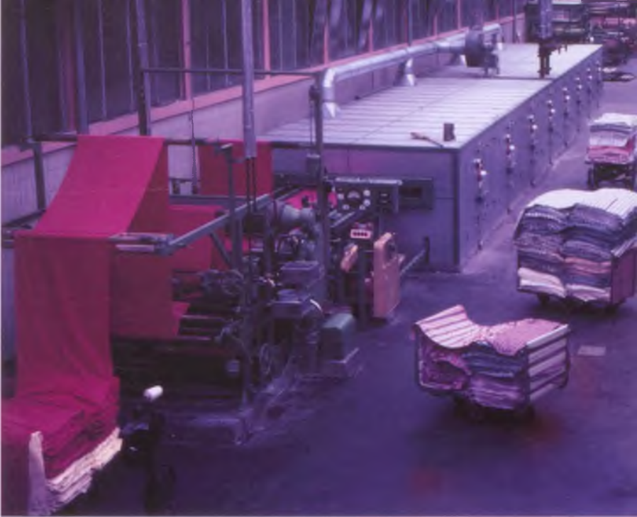
Kranzrahme von 1940. Hier verkürzt neu aufgestellt im Veredlungsbetrieb Fischbach
