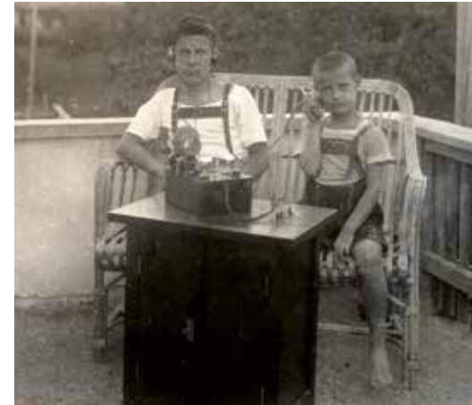
Abb. 1: Beim Radio der Brüder Scheuermaier handelte es sich um einen Detektorempfänger mit Kopfhörerempfang. Erkennbar ist die oben aufgesetzte Schwingkreisspule. Das Patent auf den Radiodetektor hatte Carl Josef Michel aus Wien im Jahre 1930 erlangt
