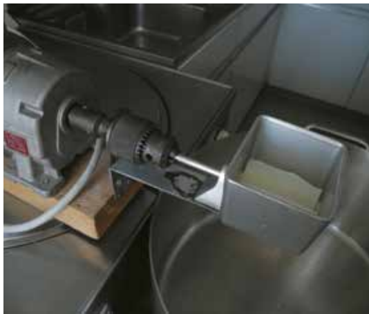
Abb. 35: Die Kupplung zwischen Getriebe und Drehspachtel
