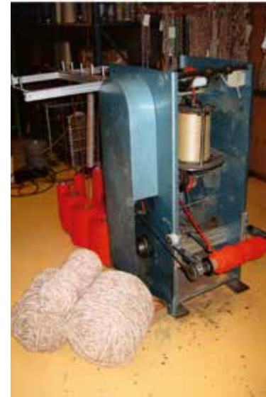
Abb. 18: Kräuselmaschine für die Handwebefirma von Karl Amann
