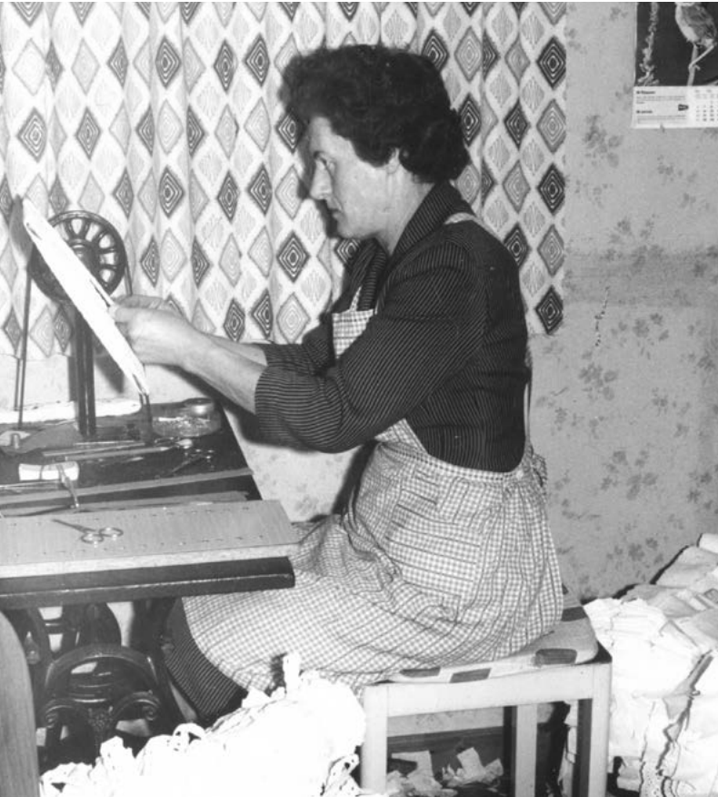
Irma Gruber an einer Wickelmaschine, Lustenau 1962. Das Aufwickeln von Stickereibändern war eine weit verbreitete Heimarbeit. Die Maschinen wurden oft einfach auf alten Nähmaschinengestellen montiert. | Foto: Eva Schönherr, Lustenau
